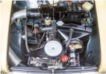
*Der extra für die Arabella entwickelte Boxer-Vierzylinder (897 ccm) leistet im Lloyd (1959-1963) 38 PS bei 4800 U/min, im abgebildeten Borgward (1960-1963) 45 PS bei 5'300 U/min*
