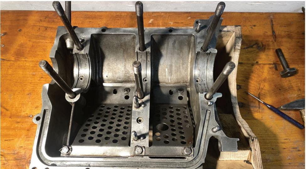
Es folgt das Reinigen aller Teile. Da hat sicher jeder seine eigene Art. Es ist auch abhängig vom Zustand der Teile. Zuerst nehme ich meist Bremsenreiniger zum Entölen und Entfetten der Teile.
