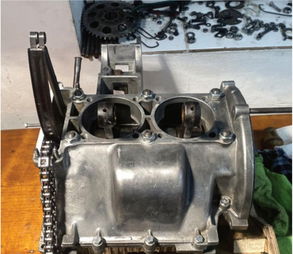
Nächster Schritt ist das Lösen der vier M 8 Schrauben unter den Blechen zur Ventileinstellung. Auch diese sind mit Sicherungsblechen gesichert. Nach dem Lösen der Schrauben kann man das Nockenwellengehäuse abnehmen.
