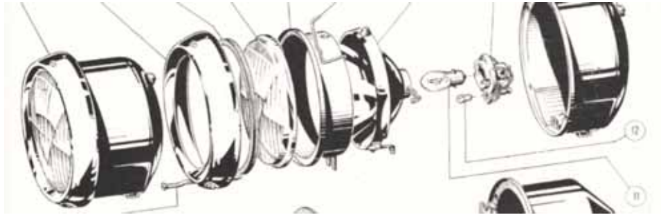
Scheinwerfer Hella, symmetrisch mit konvexem Glas für LP 600 und Alexander
