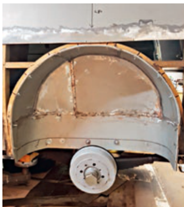
RADHÄUSER Die große Herausforderung bei den Radhäusern ist, die dreidimensionale Form genau nachzuempfinden
