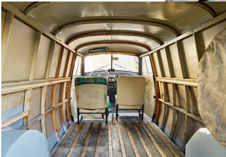
LADE(T)RAUM Das hölzerne „Knochengestütze“ und die Dielen sind original, über den Radhäusern hat Pätzold auf beiden Seiten eine Zusatzstrebe eingesetzt
