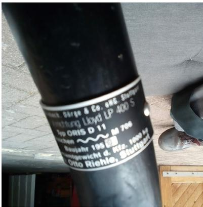
Ein Original-Typenschild ist unter dem Kugelkopf aufgenietet. Von der Firma Otto Riehle Stuttgart. Diese hat in den 50er Jahren für Lloyd die Kupplungen hergestellt. Eine Kopie vom Fahrzeug-Brief , worin die Daten der Anhängelast stehen hatte mir Herr Peifer mitgeschickt. Für die netten Damen bei der Zulassungsstelle.
